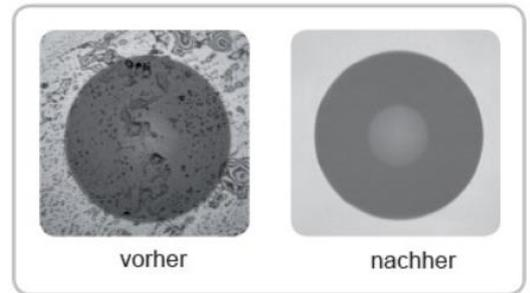
Die IBC-Cleaner sind sehr praktische und effiziente Reinigungsgeräte für das Reinigen von Steckern durch das Mittelstück oder direkt am Stecker, Komponentenanschlüssen sowie Messgeräte mit LWL Ein- oder Ausgänge. So werden z.B. Stecker hinter dem Panel bequem und effizient von vorne durch das Mittelstück hindurch gereinigt. Mit einem IBC-Cleaner können über 500 Reinigungen getätigt werden.
