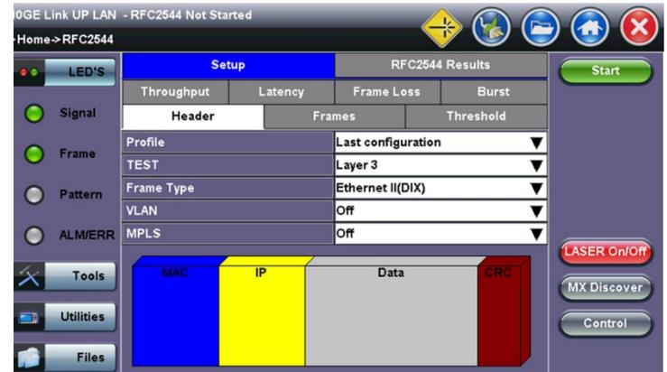
Das am meisten verbreitete und anerkannteste Testverfahren im Ethernet Testing Umfeld ist der RFC2544 Test. Ursprünglich wurde dieser für die Hersteller von Netzwerkequipment entwickelt und eingesetzt in den Laboren von IBM, HP, Cisco, Juniper, Broadcom und wie sie alle heissen. Seit Jahren wird dieses Testverfahren aber auch erfolgreich eingesetzt, um ganze Netzwerke und einzelne Services zu testen.
